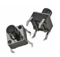
Тактовая кнопка RUICHI KAN0610-0731B, 6х6х7 мм, OFF-(ON), 50 мА, 12 B, 100 мОм – это разновидность простейших механических выключателей, обеспечиваю щая замыкание контактов (без фиксации) то лько при наличии давления на поверхность штока (толкателя).
